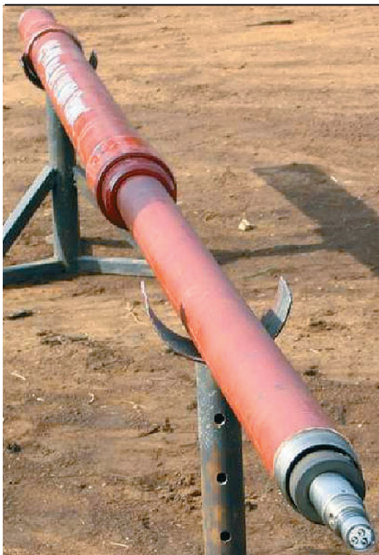
Рис. 1. Общий вид компоновки с электроклапанами ОРД-2РЭК-2БТ на два пласта с дискретной регулировкой клапанов
