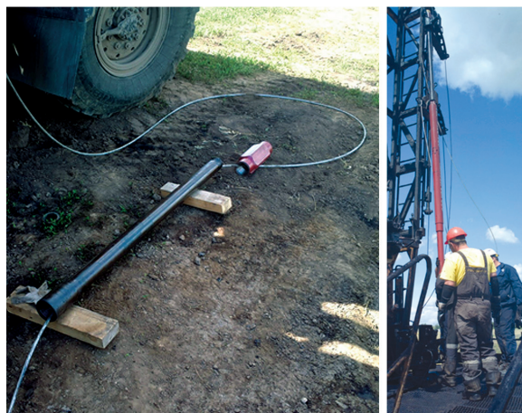
Рис. 12. Геофизический кабель для передачи телеметрии и управления РЭК (слева), компоновка ОРД-2РЭК-2БТ-ГК перед спуском (справа)
