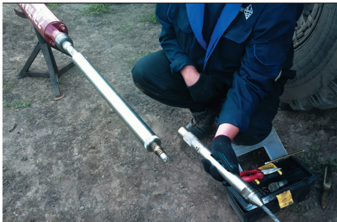
Рис. 11. Блок датчиков суммарного потока РТС с узлом для подключения геофизического кабеля
