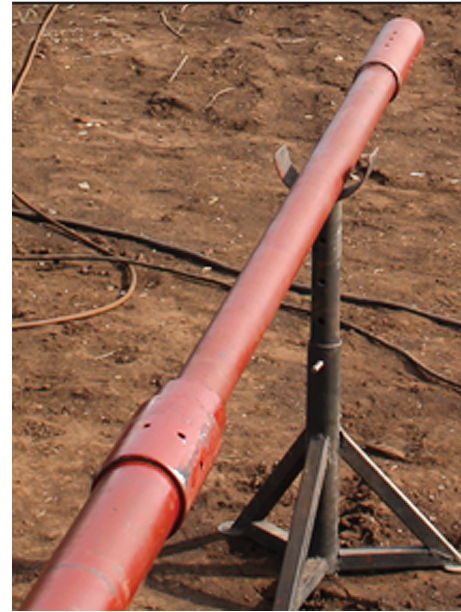
Рис. 4. БРПУ и муфта перекрестного течения выхода флюида из верхнего и нижнего пластов
