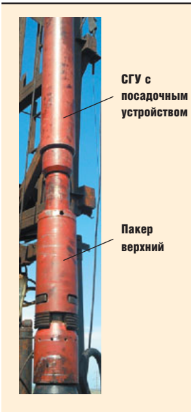
Рис. 3. Первый этап установки. Спуск пакерной системы
